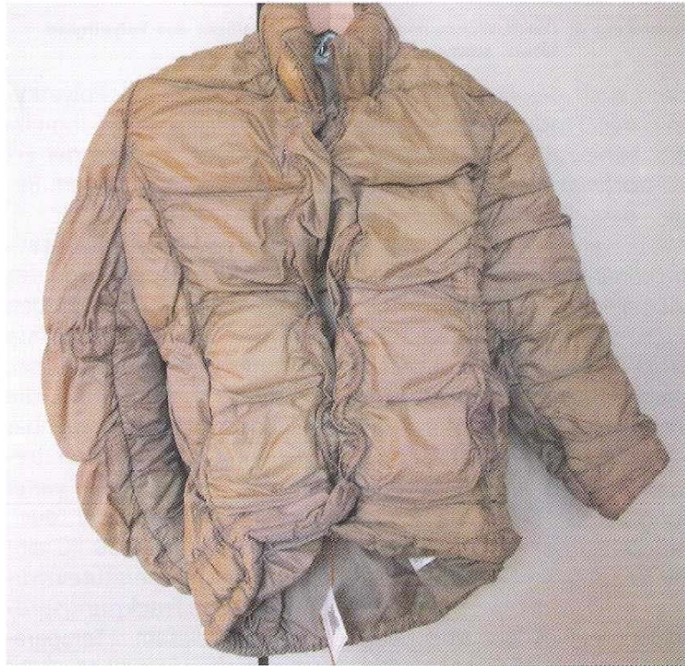
Abbildung 1: Deformierung einer Daunenjacke durch eine geschrumpfte Daunenabdeckung
