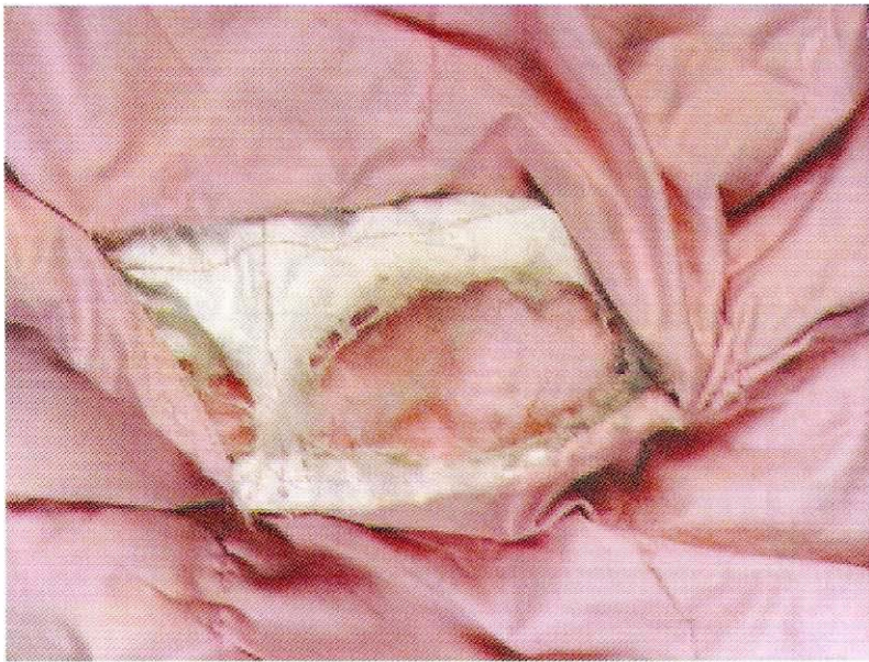
Abbildung 2: Durch Wärmeeinwirkung können Vliese aus Polyethylenfasern schmelzen
